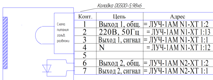
Рис.8. Выходные электрические цепи фотодатчика ФД-05ГМ.
