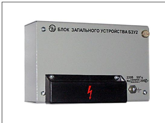
Блок запального устройства БЗУ2 (далее-блок) предназначен для формирования импульсов управления автомобильной катушкой зажигания в схемах розжига топлива тепловой установки. Блок совместно с автомобильной катушкой зажигания обеспечивает формирование искровых разрядов между электродами разрядника в воздушном промежутке не менее 8 мм.
