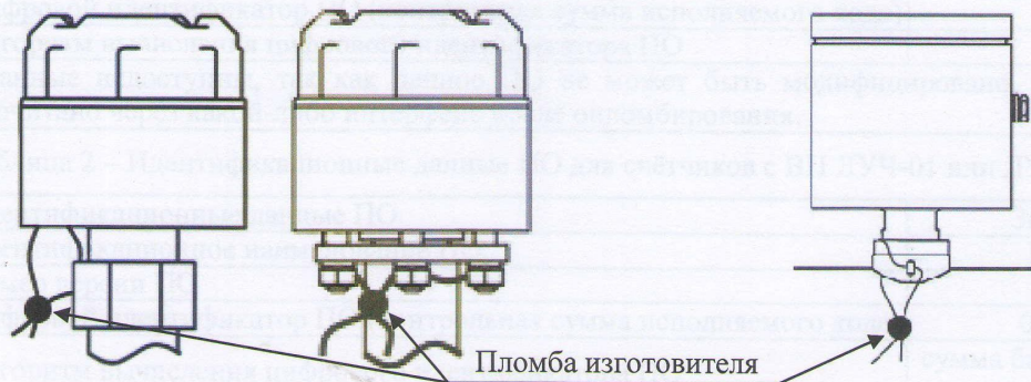
Рисунок 17 – Схема пломбировки ВП ЛУЧ-01 и ЛУЧ-02
