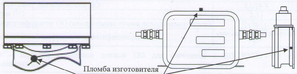
Рисунок 18 – Схема пломбировки ВП ЛУЧ-03 и ЛУЧ-04
